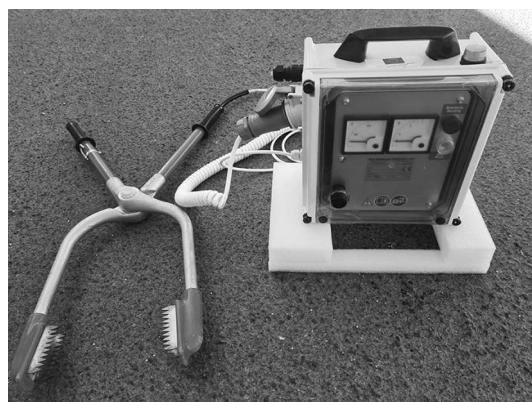
*Slika 1. Električni generator sa transformatorom i kleštima*
